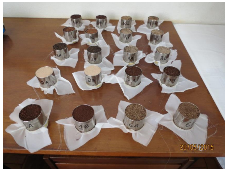
Figura 3 – Metodologia para cálculo da densidade seca ao ar.
