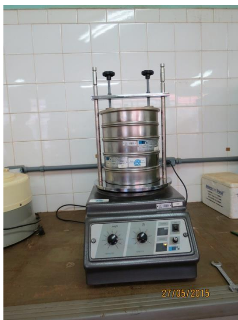
Figura 2 - Aparelho agitador mecânico para determinação da granulometria
