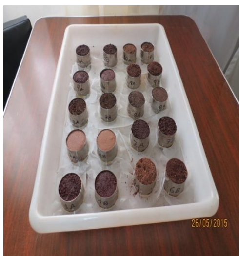
Figuras 4 e 5 – Amostras saturadas (A) e metodologia da mesa de tensão (B).
