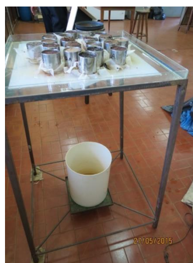
Figuras 4 e 5 – Amostras saturadas (A) e metodologia da mesa de tensão (B).
