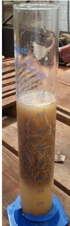
Figura 5 - Densidade radicular pelo método do volume deslocado
