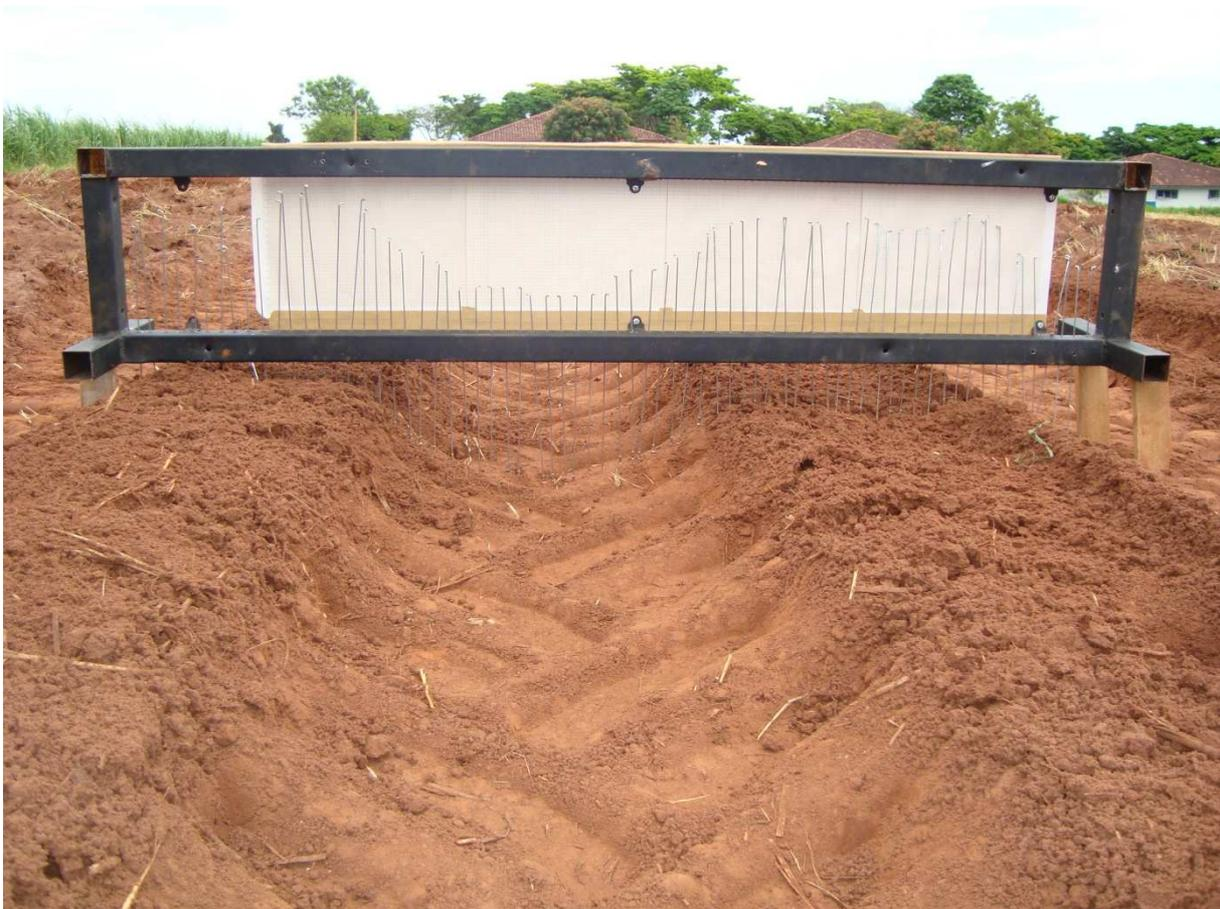
**Figura 2** – Perfilômetro desenvolvido para medição do recalque do pneu.
