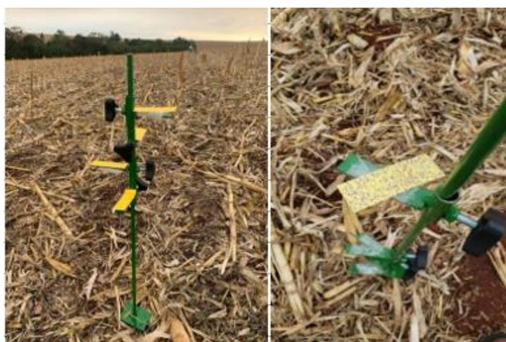
O auto propelido percorreu 50 metros estabilizando em 7 km.h<sup>-1</sup> (primeiro ponto de coleta), depois mais 50 metros enquanto estabilizava em 15 km.h<sup>-1</sup> (segundo ponto de coleta) e da mesma forma até a coleta com velocidade de 21 km.h<sup>-1</sup>, (terceira amostra), com um papel hidro sensível de cada lado da barra de pulverização distribuídos de forma casual.
