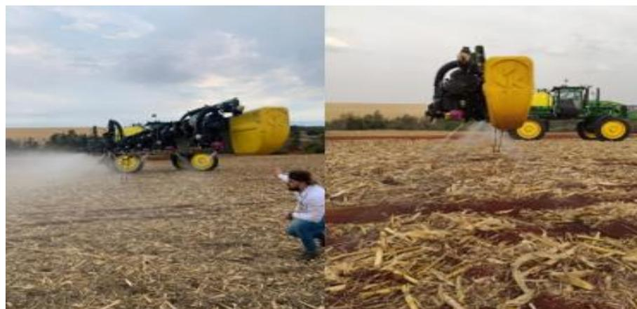
O pulverizador foi equipado com torres de aplicação (porta-bicos) com 6 pontas cada (Figura 3), sendo que foi utilizado somente a ponta 3d hypro azul (PS3DQ0003) que indica uma vazão-padrão de 0,3 galões americano por minuto (1,13 litros por minuto), em pontas sem desgaste quando pressurizadas a 40 PSI, na tecnologia convencional. A vazão escolhida para o
